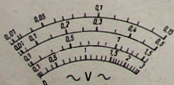
Bild 7. Skaleneichnung des Röhrenvoltmeters
